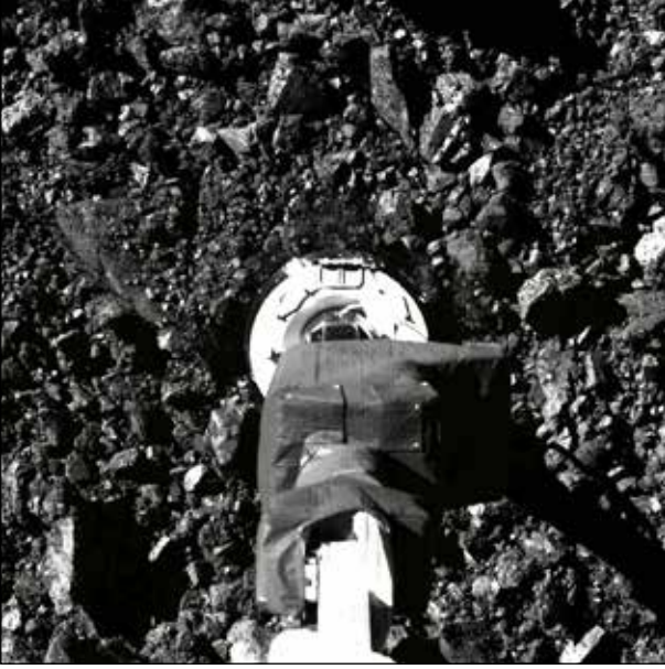
‘ओसिरिस-रेक्स’चा यांत्रिक हात बेन्नूवरून नमुना उचलतानाचा यानावरील बसवलेल्या कॅमेराने घेतलेला फोटो.
