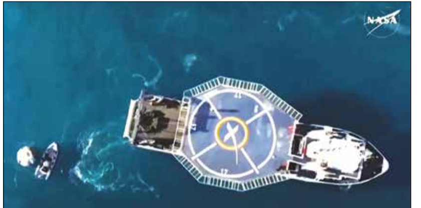
कुपीला होडीवर घेण्यासाठी बनवलेला प्लॅटफॉर्म
